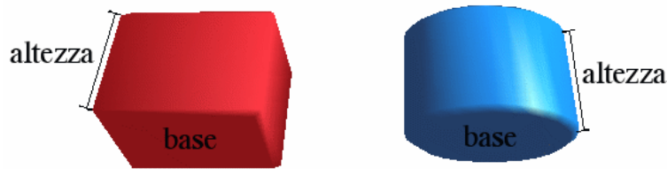
Fig. 4. A destra un parallelepipedo, a sinistra un cilindro. Per entrambi il volume è calcolato mediante la formula area di base per altezza.
